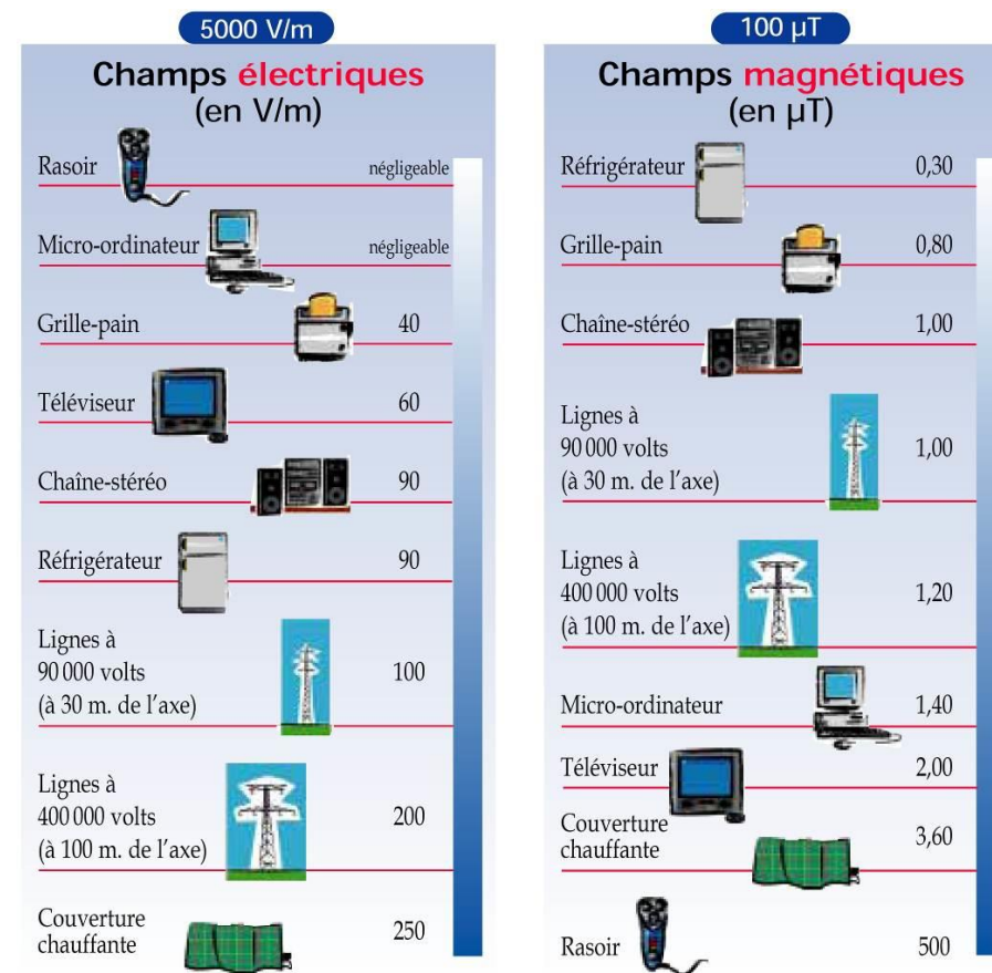
Figure 350 : Exemple de valeurs de champs électriques et magnétiques d'appareils électriques d'usage courant et lignes électriques
